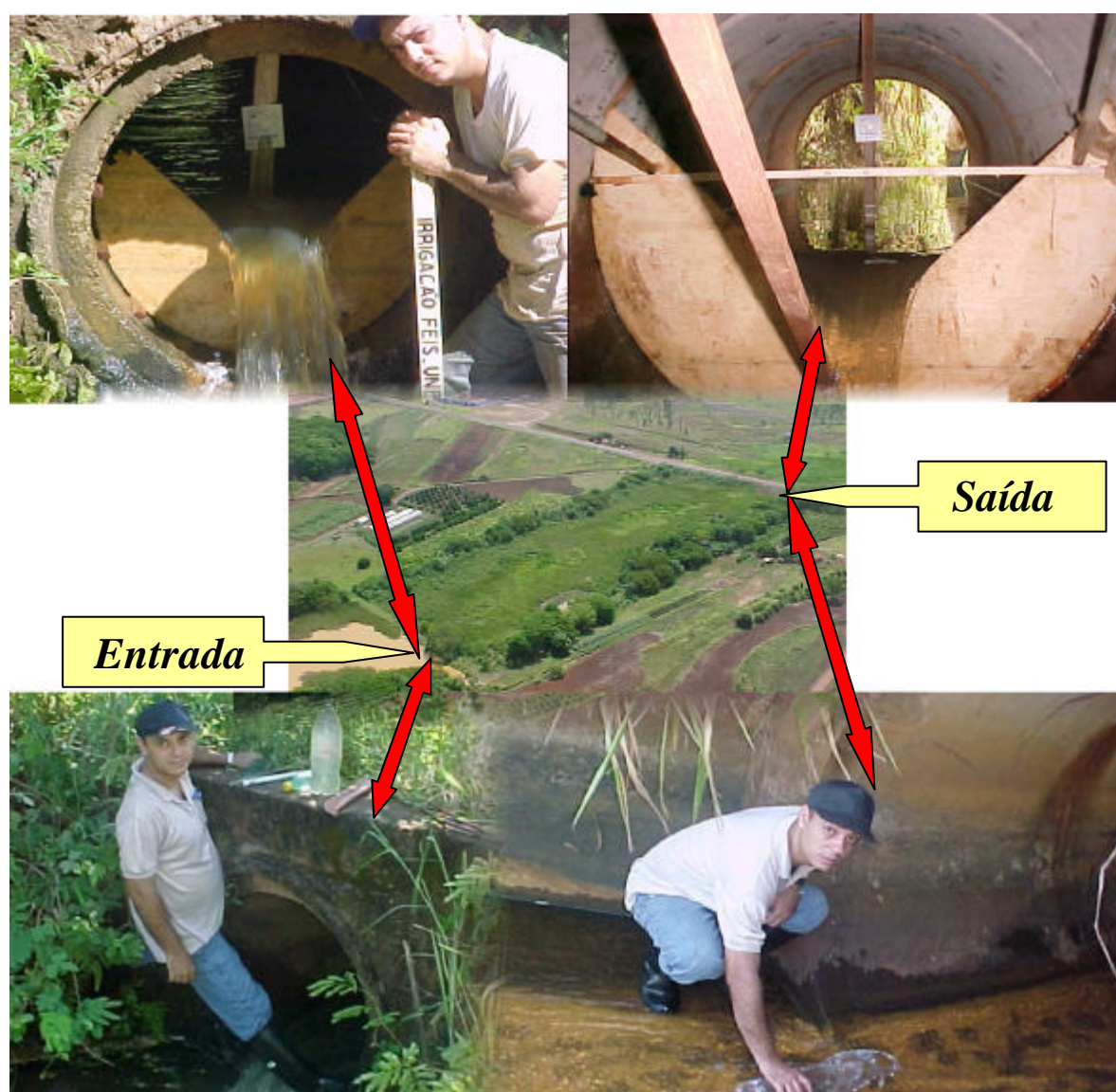
FIGURA 13 - Ilustração das medições de vazão e da coletas de água a montante e a jusante da área experimental.
