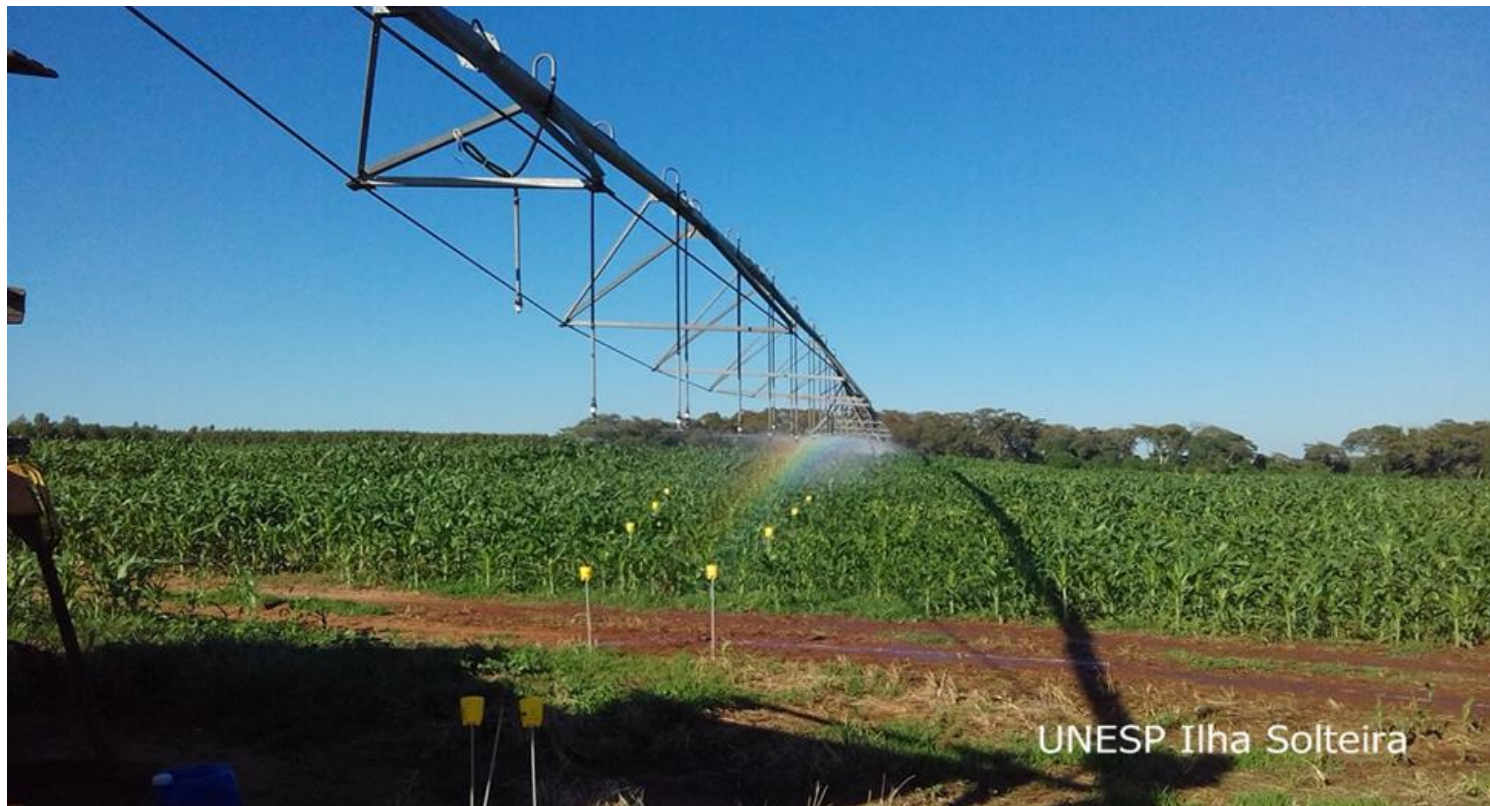
Figura 3 - Disposição dos coletores no campo formando ângulo de 3^\circ .
