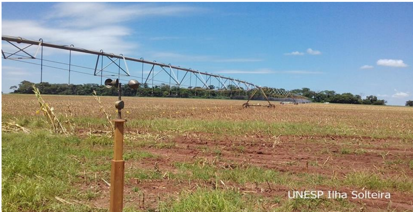
Figura 6- Anemômetro utilizado para aferir a velocidade média do vento durante o teste.
