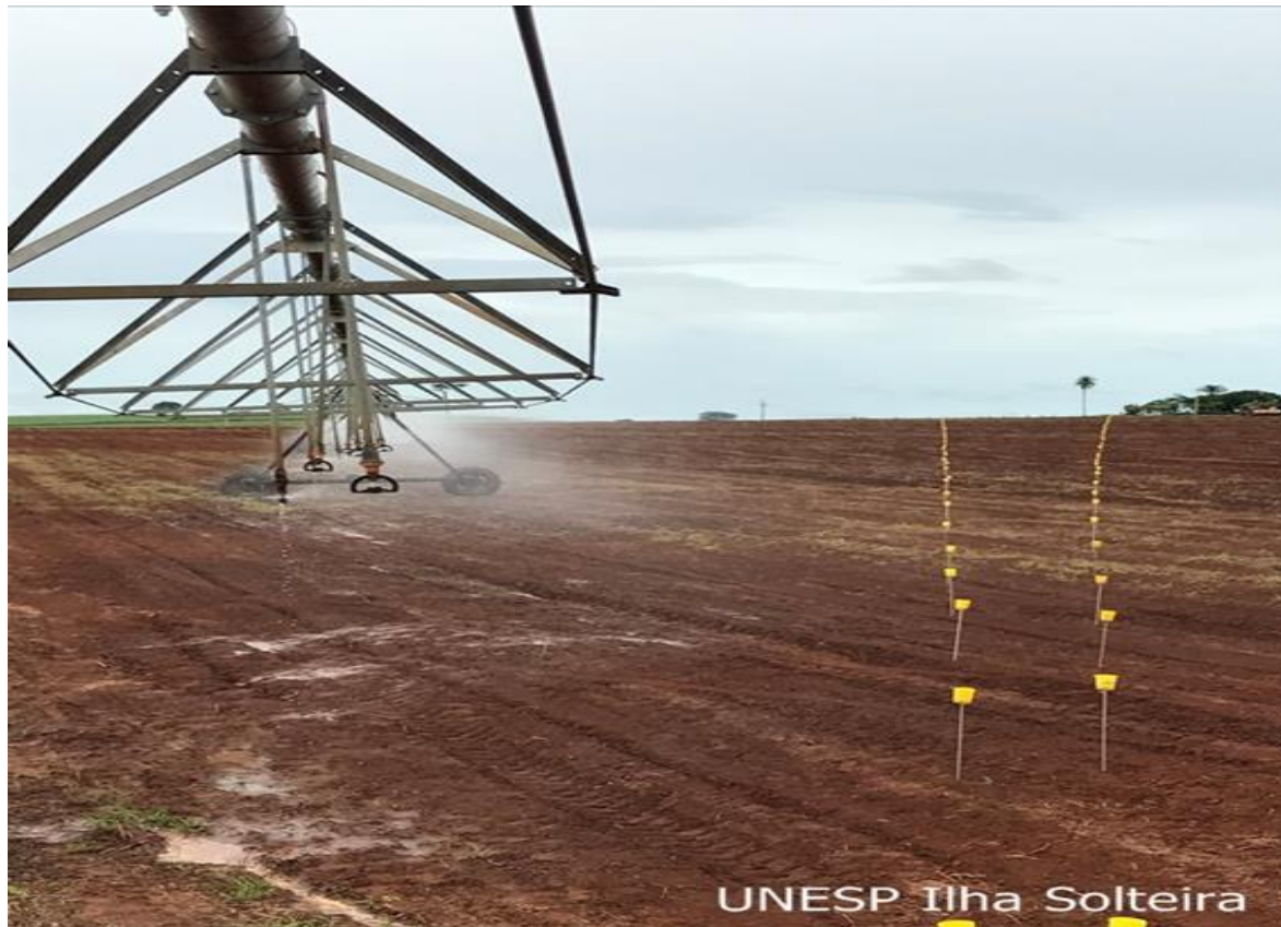
Figura 4 - Disposição dos coletores no campo formando ângulo de 3^\circ .
