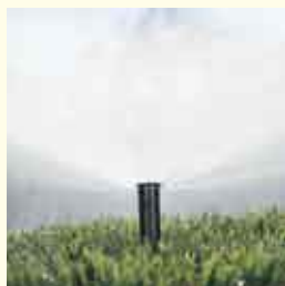
Sem regulador Nebulização, perdas de água pelo vento
