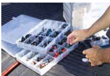
Os bicos com código de cores permitem uma fácil identificação e armazenagem.
