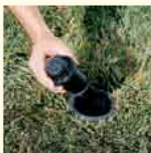
2 Coloque o bico no ATR e de seguida introduza este último no copo que está no terreno.
