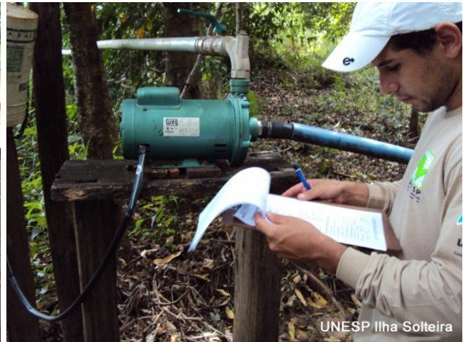
Figura 4. Coleta dos dados técnicos do conjunto moto-bomba.
