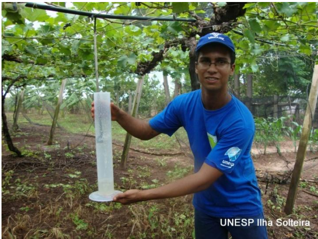
Figura 5. Avaliação da irrigação em um sistema de microaspersão invertida.
