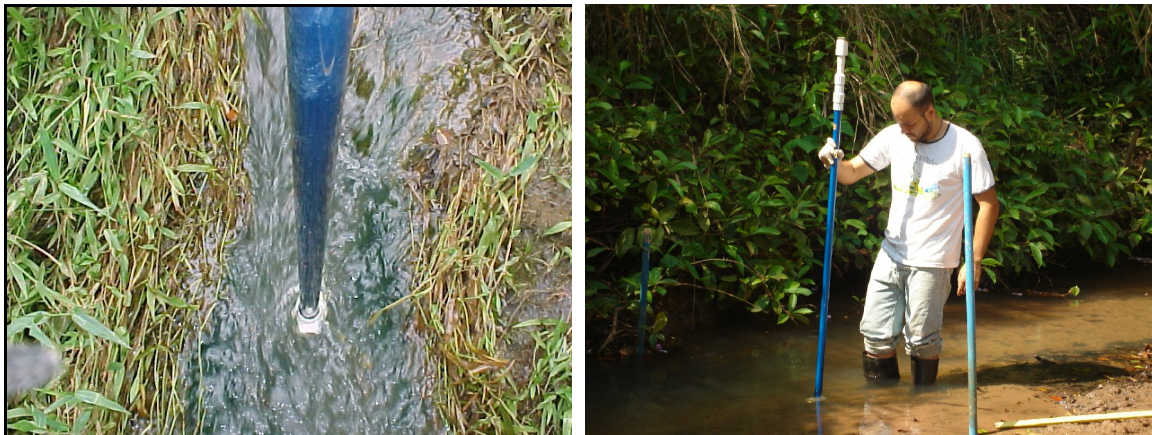
Figura 15. Medição de vazão em 11/10/2007 utilizando o molinete hidrométrico, da marca FP101-FP201 Global Flow Probe.
