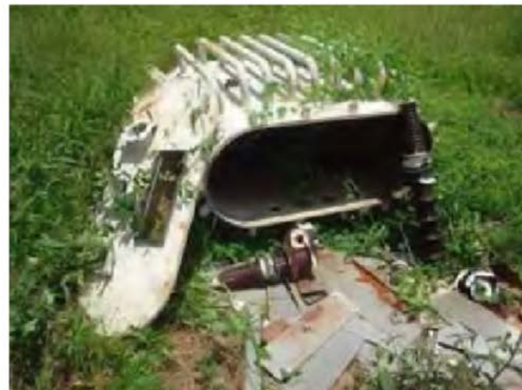
Foto - Transformadores destruídos pela ação de saqueadores para a obtenção de fios de cobre
