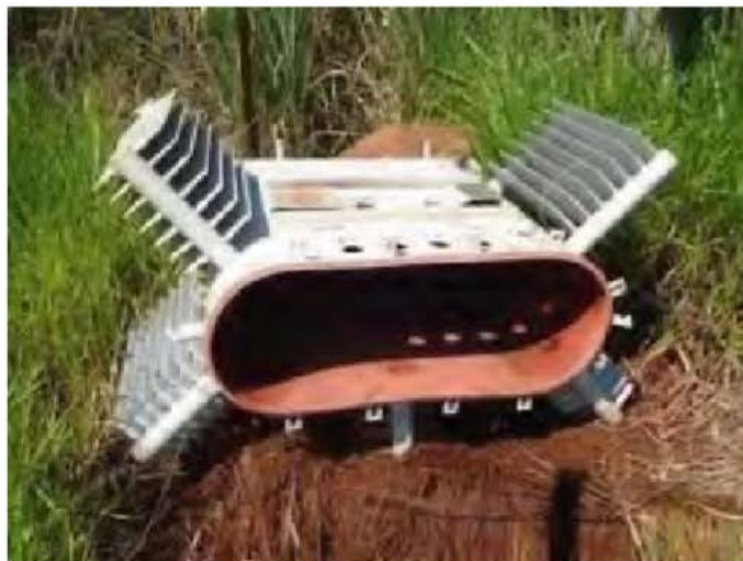
Foto - Transformadores destruídos pela ação de saqueadores para a obtenção de fios de cobre
