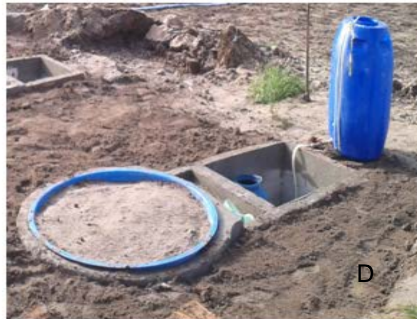
Figura 2. Lisímetro de lençol freático de carga constante, caixa de polietileno (A), tanque intermediário (B) e tanque medidor (C) instalado em Mutuca- PE.
