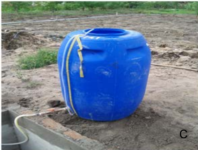
Figura 2. Lisímetro de lençol freático de carga constante, caixa de polietileno (A), tanque intermediário (B) e tanque medidor (C) instalado em Mutuca- PE.
