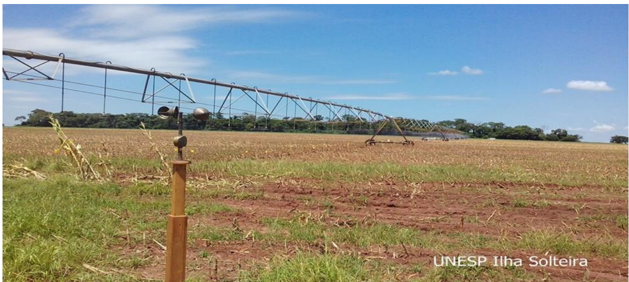
Figura 6 - Anemômetro utilizado para aferir a velocidade média do vento durante o teste.
