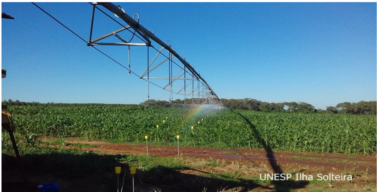
Figura 3 - Disposição dos coletores no campo formando ângulo de 3°.
