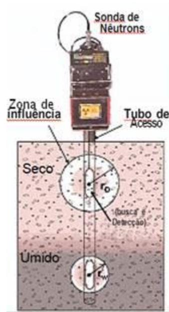
Detalhes de uma Sonda de Nêutrons
