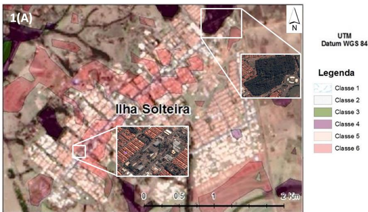
Figura 1(A): Mapa de temperatura da superfície do município de Ilha Solteira – SP, com a banda 10 cortada, sem nuvens. Formula completa: TC = (1321,08 / \ln(774,89 / (3,3420E-04 * \text{banda10.tif} + 0,10000) + 1)) - 273,15 (USGS, 2014)
