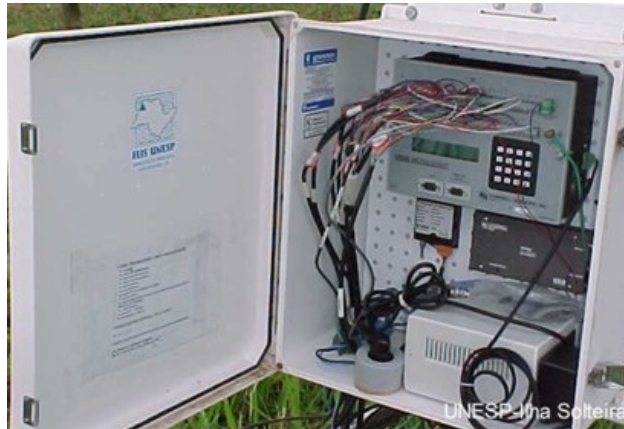
FIGURA 3: Sistema de aquisição de dados agrometeorológicos
