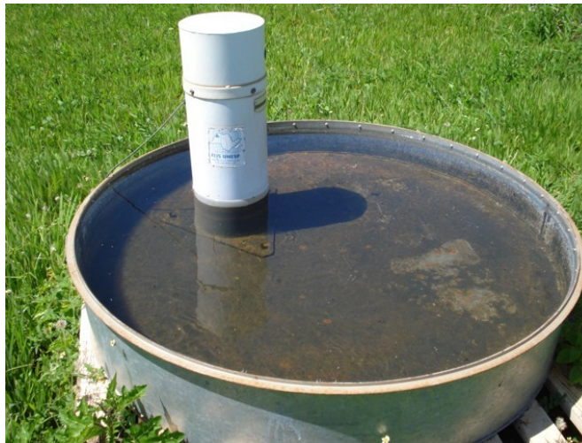
FIGURA 4: Tanque Classe A com poço tranquilizador instalado em área gramado sobre o estrado de madeira.
