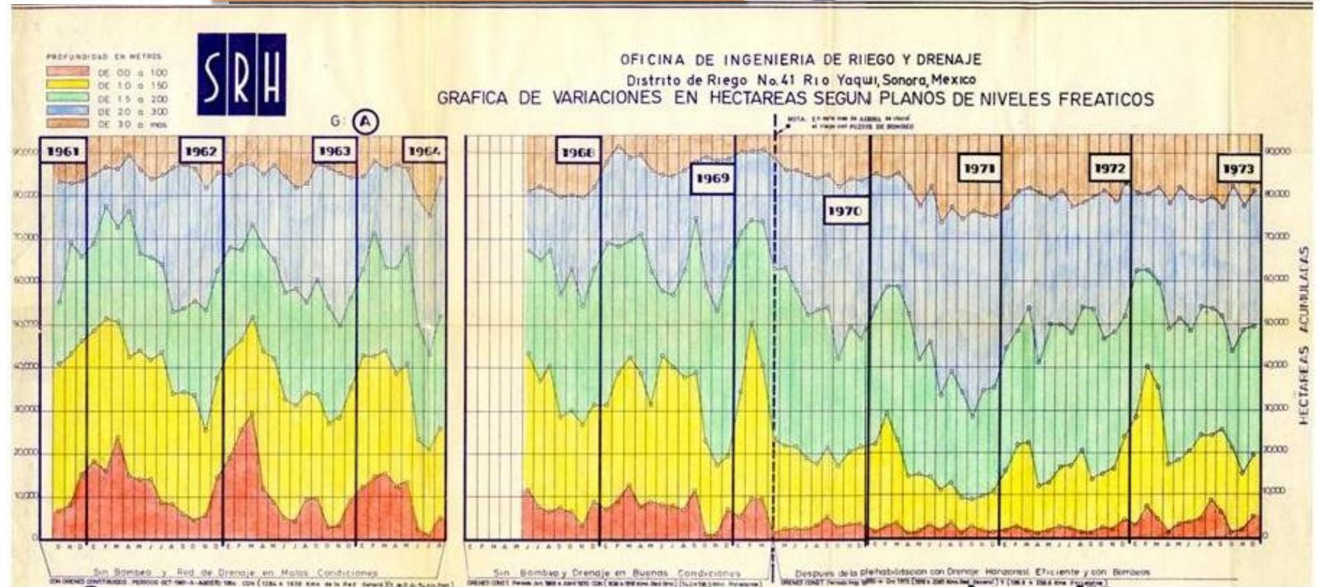
Detalle de una gráfica “áreas-tiempo” del distrito de riego No. 41, Río Yaqui, Son., donde se aprecia la variación de las áreas con diferente rango de profundidad del nivel freático..
