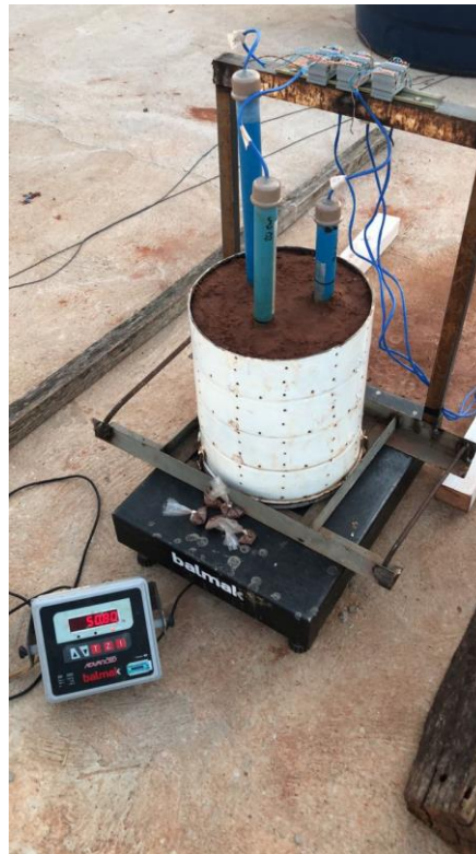
Figura 26 - Método de Pesagem por diferenças sequenciais diárias (capacidade de campo).
