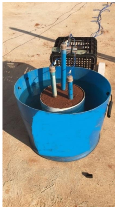
Figura 25 - Método de Pesagem (amostra saturada).
