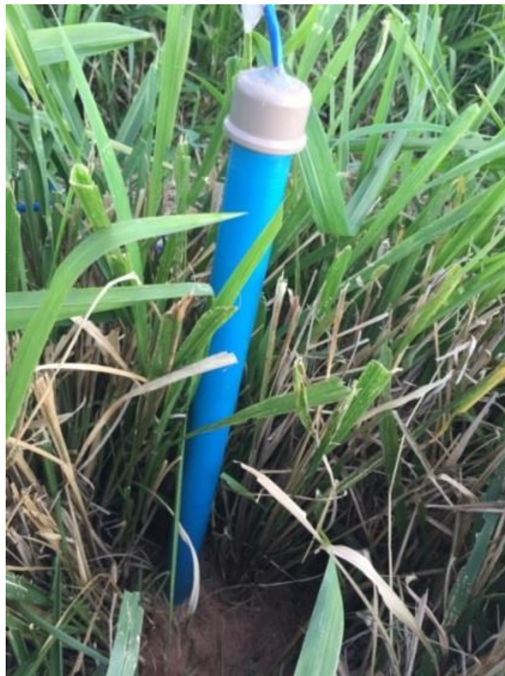
Figura 30 - Sensor de umidade de solo instalado na cultura do Capim Mombaça
