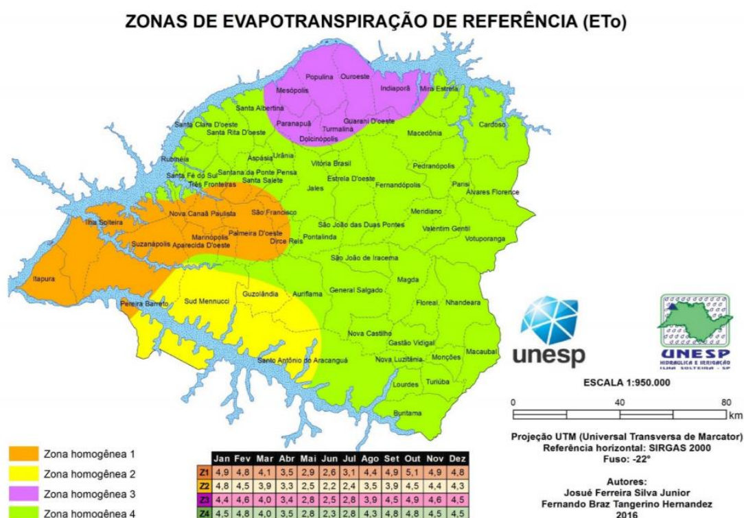
Figura 6 - Mapa representativo das Zonas Homogêneas e valores estimados mensais da evapotranspiração, em mm dia -1 , para cada diferente Zona.
