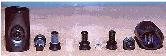
Figura 182: Exemplo de gotejadores com dispositivos antisucção.
