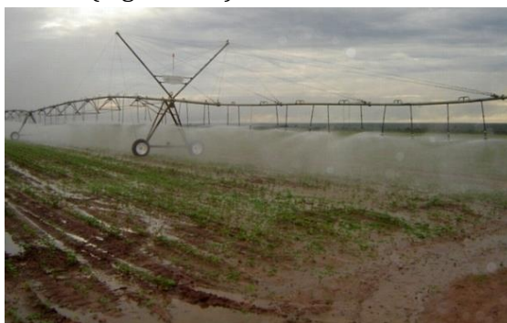
Figura 261: Pivô central apresentando escoamento superficial excessivo.
