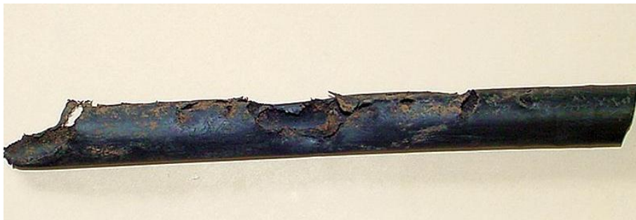
Figura 121: Exemplo de tubulação de polietileno atacada por roedor (Fonte: THOMPSON, 2014).
