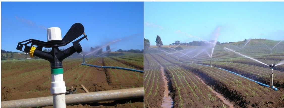
Figura 64: Detalhe de aspersores de impacto em operação no campo (Fonte: ANTUNES, 2006).
