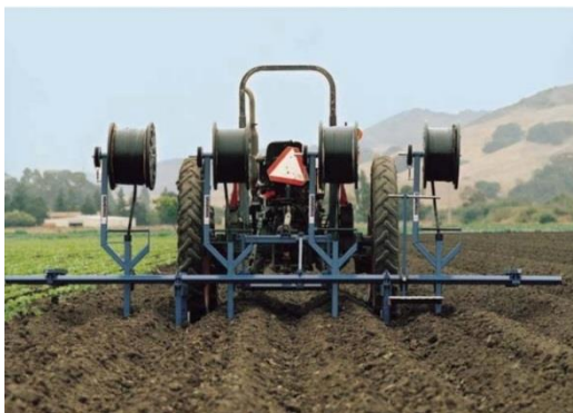
Figura 183: Detalhe de implemento utilizado para instalação de linhas laterais subsuperficiais.
