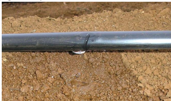
Figura 152: Detalhe de um gotejador conectado à parte interna da tubulação.
