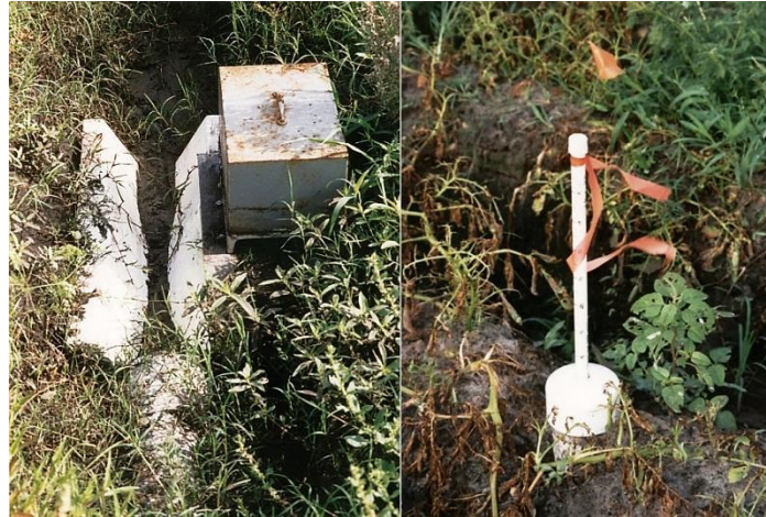
Figura 191: Detalhes de sistemas de controle utilizados na subirrigação: calha na entrada do sulco para controle da vazão (esquerda), e piezômetro para detectar a profundidade do nível do lençol freático (direita).
