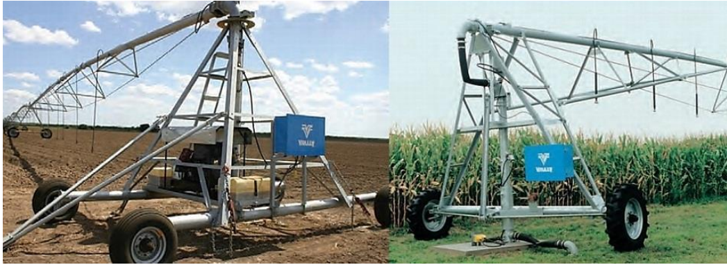
Figura 97: Modelos pivôs rebocáveis com torres centrais de quatro e duas rodas (Fonte: VALMONT, 2010)
