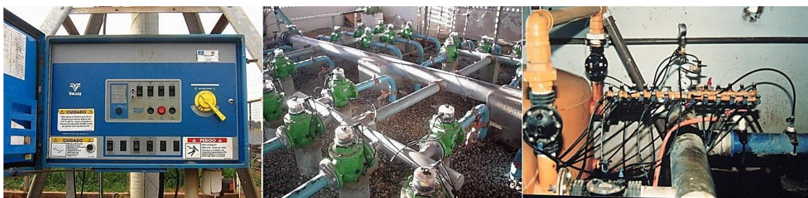
Figura 15: Exemplo de unidades de automação e controle: a esquerda, caixa de controle de pivô central, no centro, conjunto de válvulas volumétricas e a direita sistema de controle de válvulas hidráulicas.
