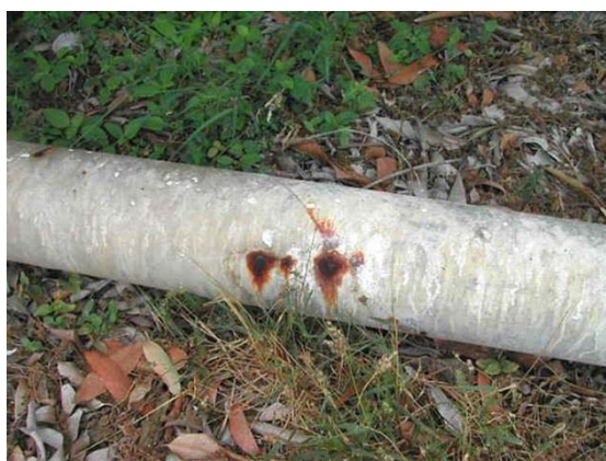
Figura 265: Exemplo de tubulação com corrosão da parede devido à qualidade de água da irrigação.
