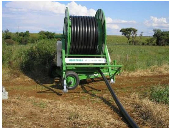
Figura 112: Exemplo de mangueira de polietileno de alta densidade utilizada em autopropelidos.
