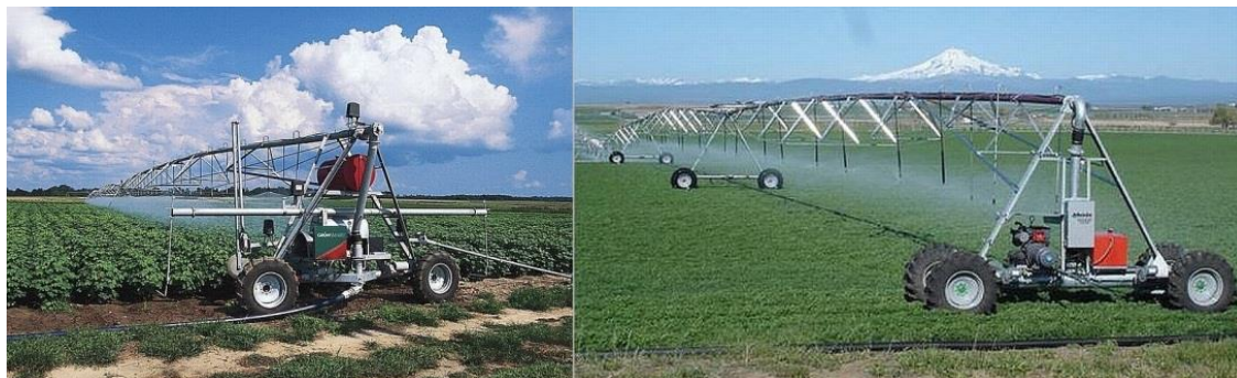
Figura 98: Detalhe de um sistema linear de irrigação com duas (esquerda) e quatro rodas (direita) abastecidos por mangueiras.
