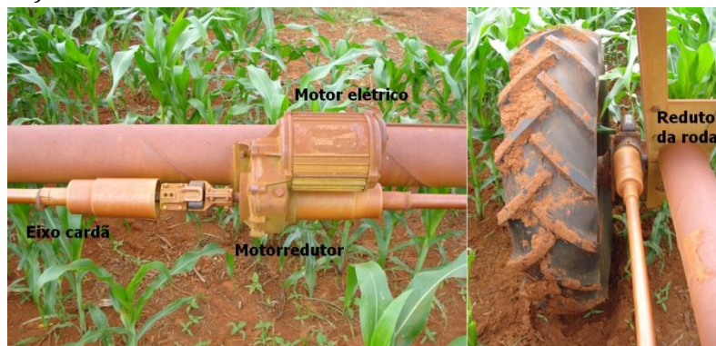
Figura 85: Detalhe do conjunto de motorredução da torre móvel (esquerda) com detalhes da transmissão de movimento por eixo cardã para o redutor de roda (direita).
