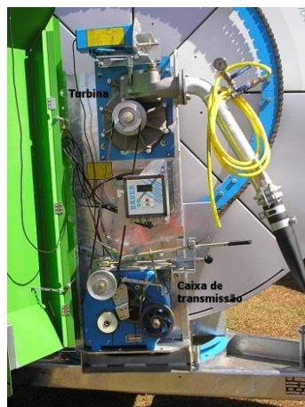
Figura 113: Detalhes de um sistema de movimentação automatizada de carretel enrolador (Fonte: BAUER, 2010).
