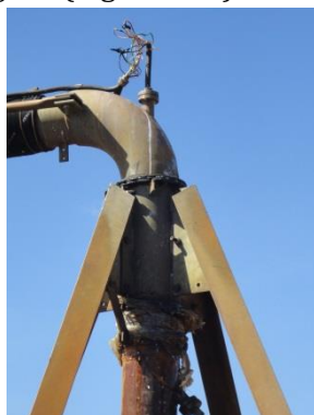
Figura 267: Exemplo de um pivô central com cabeamento desprotegido.
